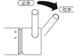
湯水の量はレバーハンドルので左右操作で調整します。
