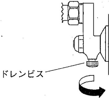
完全に水抜きが完了したら、ドレンピスを取り付けて下さい。
