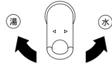
湯の温度はレバーハンドルの左右の回転で調整します。
