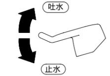
湯水の量はレバーハンドルの上下で調整します。
