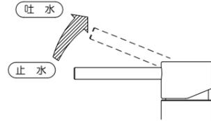
水の量はレバーハンドルの上下で調整します。
