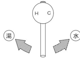
湯の温度はレバーハンドルの左右の回転で調整します。
