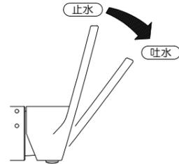
湯水の量はレバーハンドルの左右操作で調整します。
