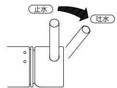
湯水の量はレバーハンドルの左右操作で調整します。
