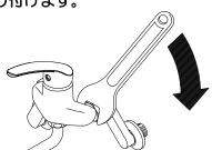
※水栓本体のナットを、モンキーレンチなどを使用し て 1960N·cm (200kgf·cm) 程度にて締付けて下
