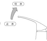
湯水の量はレバーハンドルの 上下で調整します。
