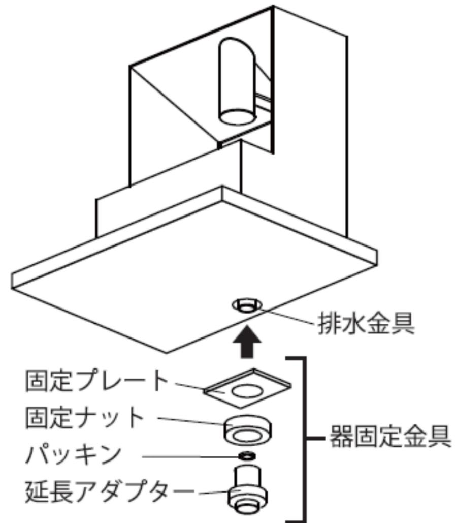
固定プレート・固定ナットを延長アダプターに通し、付属のパッキンを使って排水金具と延長アダプターを接続します。
