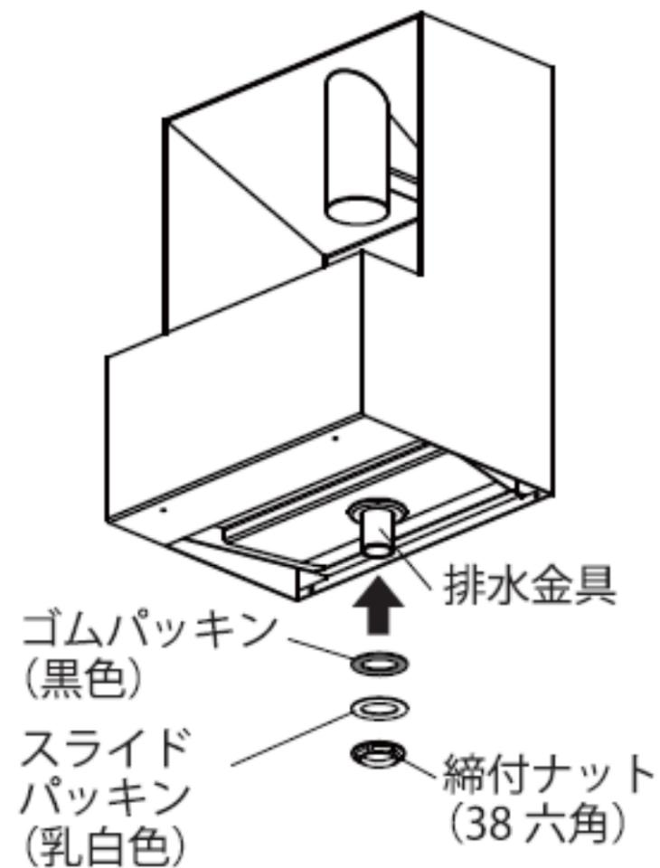
「**9** 取付け手順 (排水金具)」の方法で、排水金具を取付けます。
